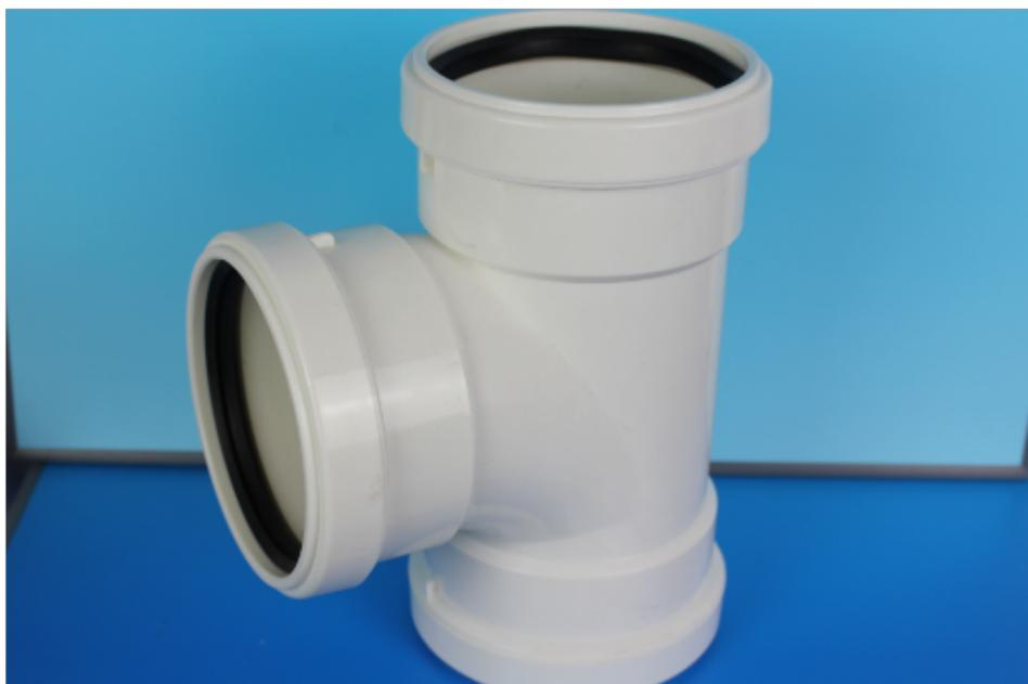
管道检查口是一个带盖板的开口短管, 拆开盖板就可以进行疏通类工作。检查口设在排水立管上及较长的水平管段上, 可以双向清理。其设置规定为立管上除建筑高层及低层必须设置外, 可以每隔两层设置1个, 平顶的建筑可用伸顶通气管顶口代替较高层检查口。当立管上有乙字管时, 在乙字管的上部应设有检查口。如果是为二层的建筑, 可以在底层设置。检查口的设置高度一般距地面1m左右, 并应高出该层卫生器具上边缘0.15m 与墙面成45夹角。江西HDPE聚乙烯单叶片螺旋排水管材销售厂家高密度聚乙烯HDPE静音排水管适用于医院酒店学校等。
